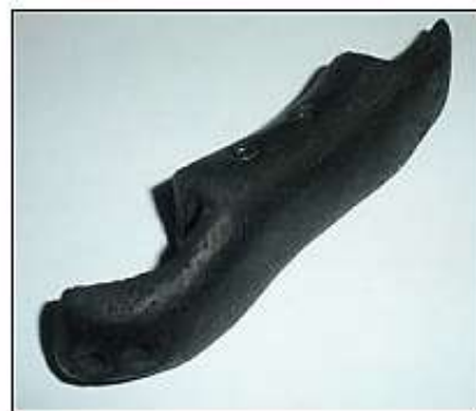
■Рис. 5. Изготовленный из УУКМ эндопротез нижней челюсти с денальными имплантатами
